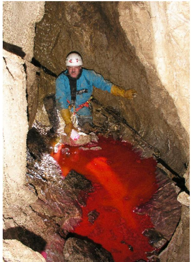
En 2003, injection de la sulforhodamine G dans la "Rivière de Beaucu" par J.Dutruit ( M.Demierre )
